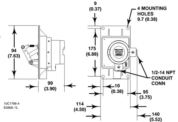
**TYPE DVC6025 ROTARY AND LONG-STROKE SLIDING STEM
