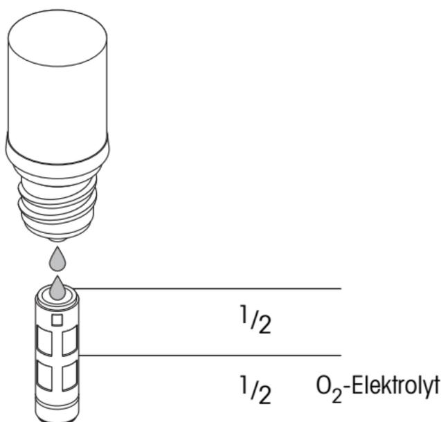
10. Den Membrankörper in senkrechter Position auf den Innenkörper schieben und überschüssigen Elektrolyt mit einem Papiertuch entfernen.
