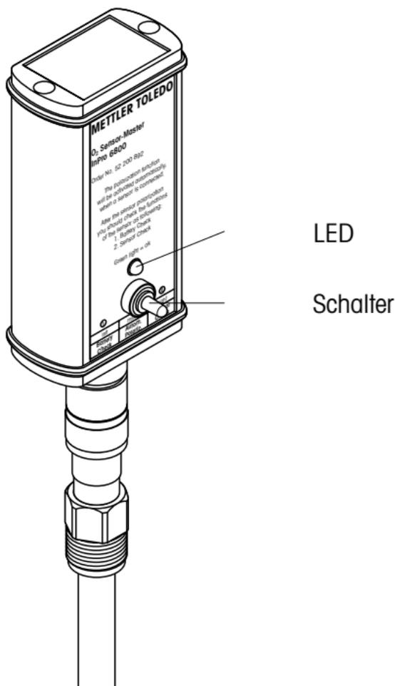
Sobald der Sensor am O<sub>2</sub> Sensor-Master angeschlossen ist, wird automatisch die Polarisierfunktion aktiviert und der Sensor mit der richtigen Polarisationsspannung versorgt. Falls der Sensor für mehr als 5 Minuten vom Transmitter getrennt war, muss er zuerst polarisiert (Polarisationszeiten siehe «Kapitel 5.1») werden, bevor aussagekräftige Testresultate erzielt werden.
