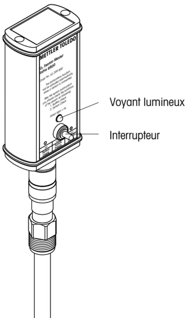
La fonction de polarisation est activée dès la connexion de la sonde au O<sub>2</sub> Sensor-Master. Si la sonde a été débranchée du transmetteur pendant plus de 5 minutes, polarisez la sonde (temps de polarisation, voir «Chapitre 5.1») afin d'obtenir des résultats de test représentatifs.
