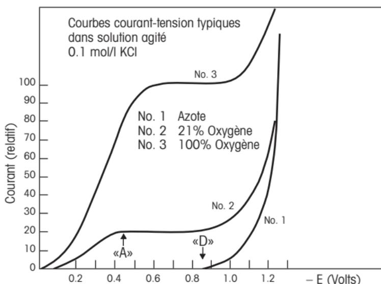
La tension de polarisation doit rester aussi constante que possible. Outre une source de tension constante, les conditions suivantes doivent également être remplies : La résistance électrique du film d'électrolyte ne doit pas dépasser une certaine valeur afin d'éviter une chute de tension.
