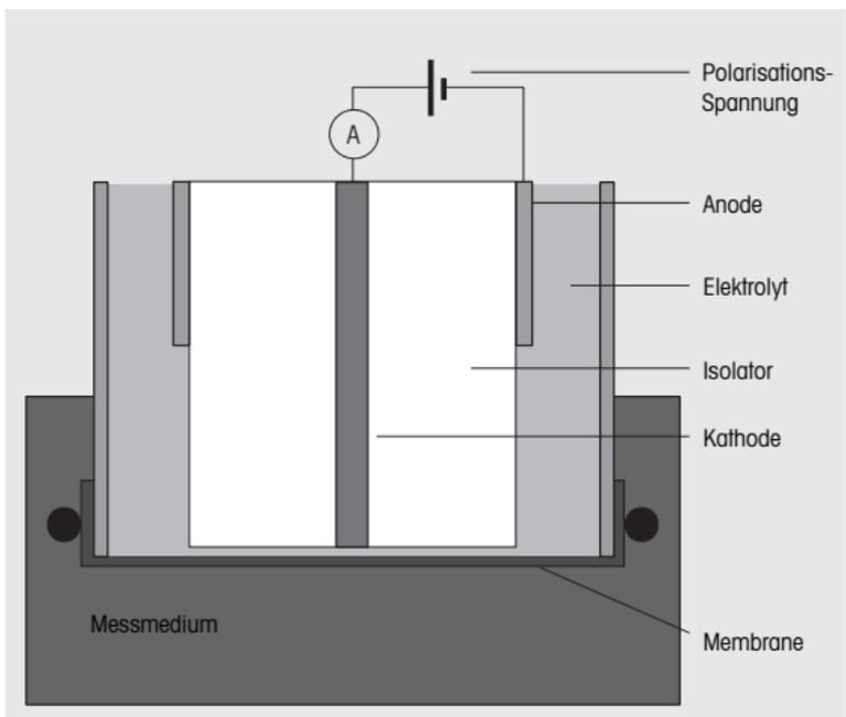
Bei den Clark-Elektroden ist die konstruktive Auslegung sehr wichtig. Speziell die Dicke des Elektrolytfilms zwischen der Kathode und der Membran muss in sehr engen Grenzen gehalten werden, um eine gute Linearität und einen tiefen Nullstrom (Strom in reinem Stickstoff) zu gewährleisten. Die obenstehende Abbildung zeigt den prinzipiellen Aufbau von Clark-Sauerstoffelektroden.
