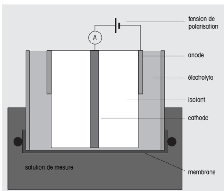
Dans le cas de l'électrode de Clark, la configuration géométrique est très importante. L'épaisseur du film d'électrolyte situé entre la cathode et la membrane doit satisfaire des tolérances très strictes, de manière à garantir une bonne linéarité et un courant de zéro faible (courant dans une atmosphère d'azote). L'image ci-dessus représente une électrode à oxygène de type Clark.
