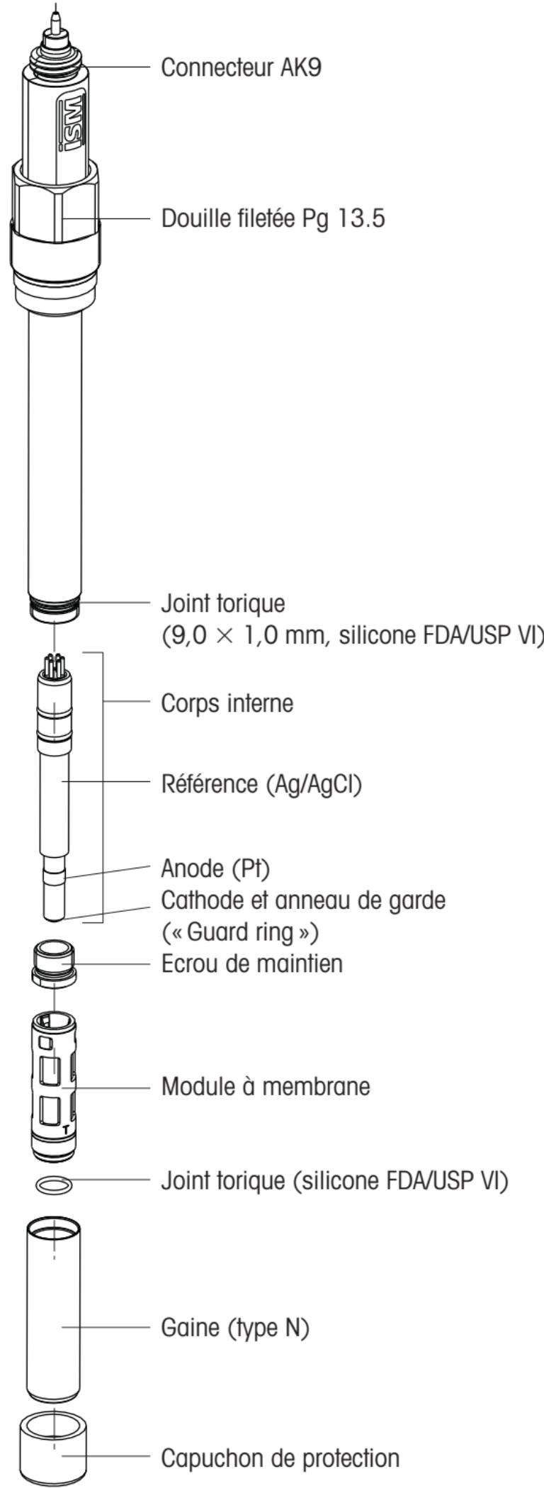
Les sondes O<sub>2</sub> METTLER TOLEDO sont livrées avec module à membrane monté, sans électrolyte et avec capuchon de protection placé. Leur fonctionnement a été testé.
