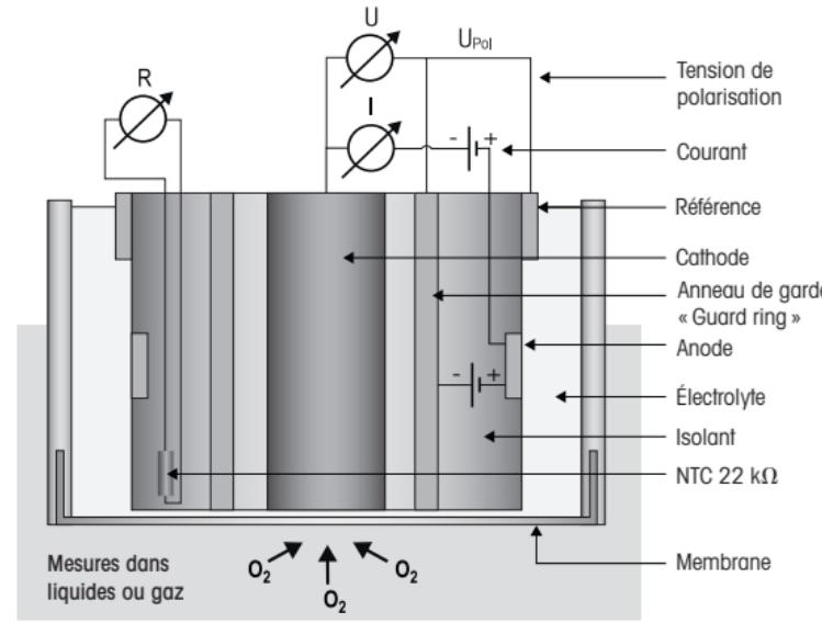
Un courant proportionnel à la pression partielle d'O<sub>2</sub> au niveau de la cathode circule donc entre la cathode et l'anode (à raison de 4 électrons pour chaque molécule d'O<sub>2</sub>).
