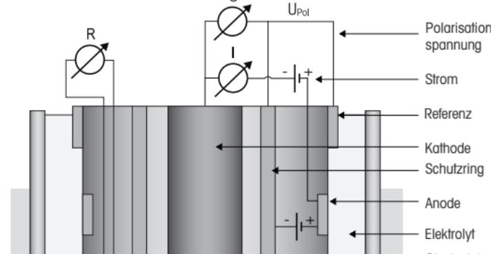
Als Folge davon fliesst zwischen Kathode und Anode ein Strom (4 Elektronen pro O<sub>2</sub>-Molekül), der proportional zum O<sub>2</sub>-Partialdruck an der Kathode ist.
