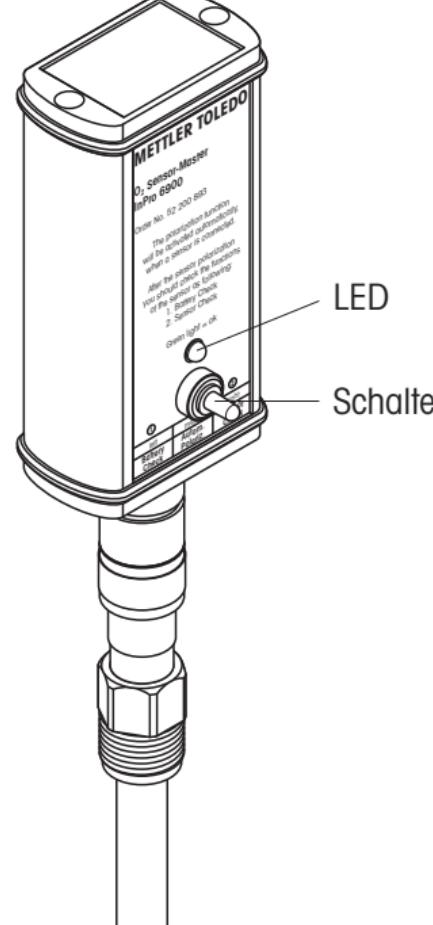
Sobald der Sensor am O<sub>2</sub> Sensor-Master angeschlossen ist, wird automatisch die Polarisierfunktion aktiviert und der Sensor mit der richtigen
