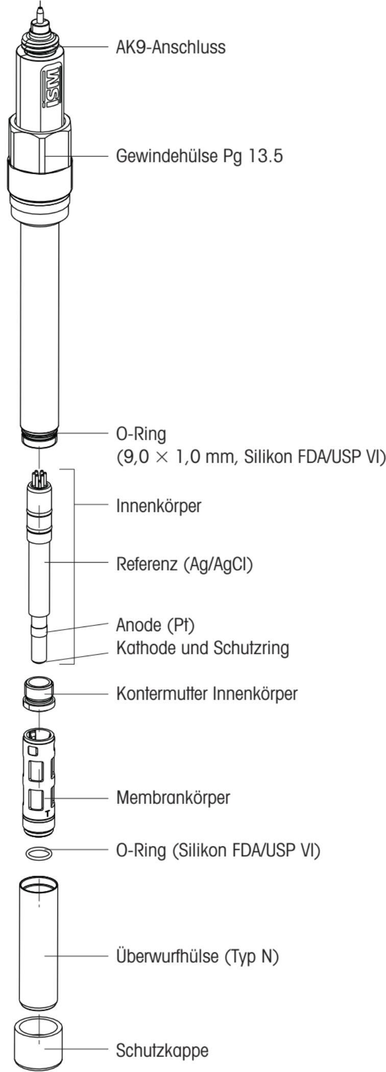
METTLER TOLEDO O<sub>2</sub>-Sensoren werden mit montiertem Membrankörper, ohne Elektrolyt und mit aufgesteckter Schutzkappe ausgeliefert und sind auf einwandfreie Funktionsweise geprüft.
